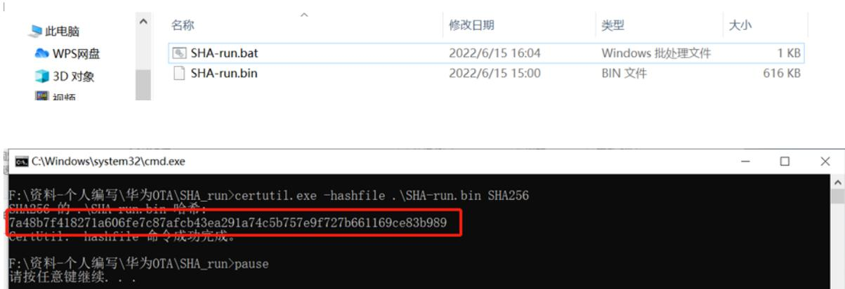
打开 package 文件夹中的 filelist.json 文件，把两个哈希值全部替换成步骤 2 中获得的哈希值保存。
