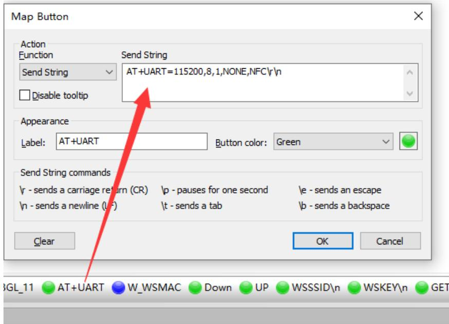
点击对应按钮，发送“+++”，模块回复“a”之后再点击发送“a”，模块回复“+ok”之后即进入命令模式。
