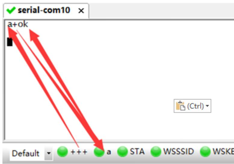
进入命令模式之后即可对模块发送指令，主界面输入的数据会立即发送出去，显示的是回显接收到的数据，下方命令栏的数据只有按回车键之后才会发送出去（下方命令栏需要工具使能之后才会显示），命令栏发送的数据带了回车符号，所以无需像按钮栏那样额外添加“\r”。
