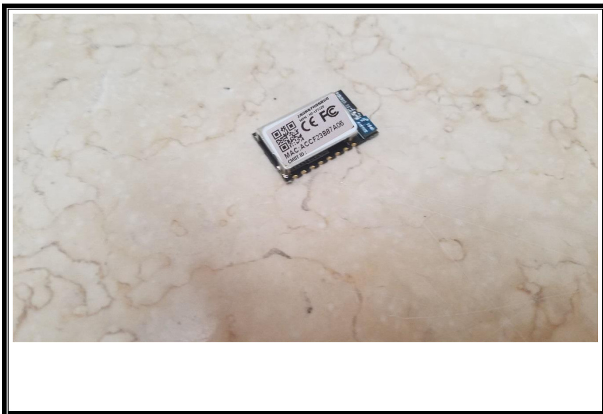
整体照 物理尺寸：长 X 宽 X 高=22mm(L)X 12mm(W)X 4mm(H)
