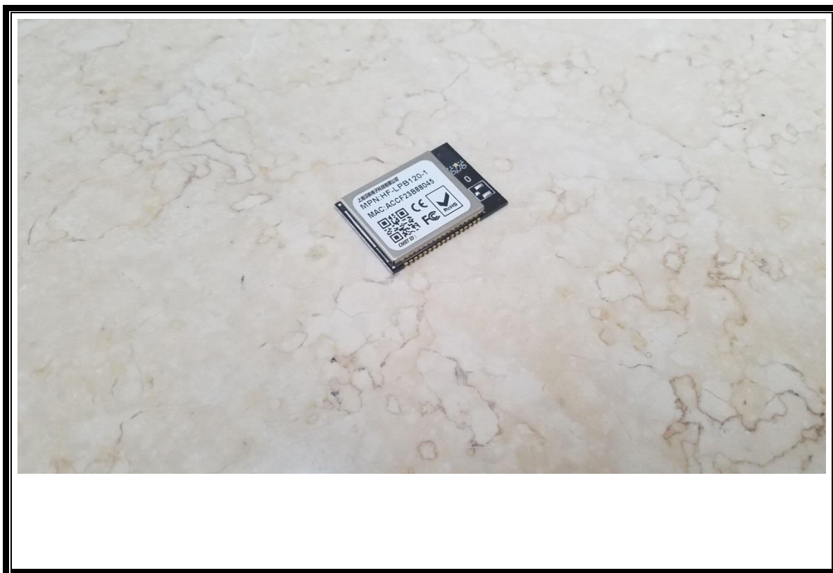
整体照 物理尺寸：长 X 宽 X 高=32mm(L)X 22mm(W)X 4mm(H)
