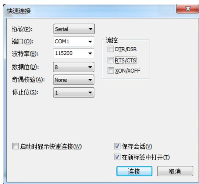
注：HF2421 设备出厂串口数据默认如上图所示，用户可以 IOTService 修改产品工作参数。
