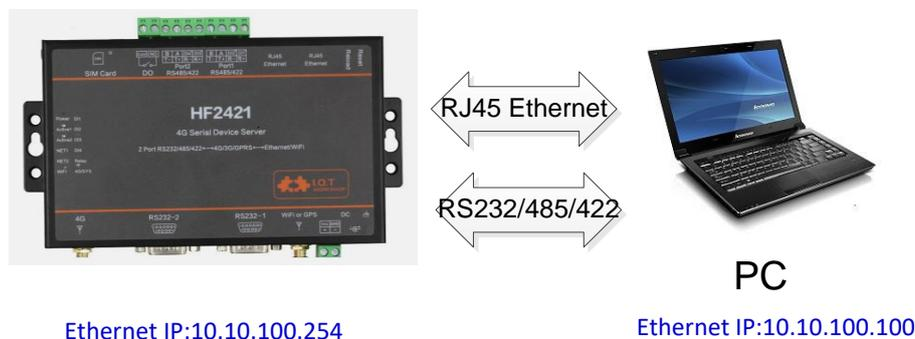
Step 1：打开网络和共享中心，除了保留本地连接禁用其余连接方式，接着用网线连接设备 RJ45 和 PC 电脑两端端口，打开 IOTService 工具后即可自动显示设备信息，如下图所示。
