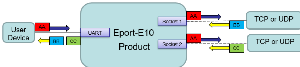
Figure 13. 多 Socket 数据传输样例
