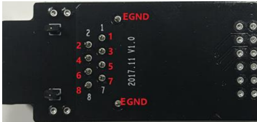
Figure 4. Eport Pro-EP20-PIN 管脚定义
