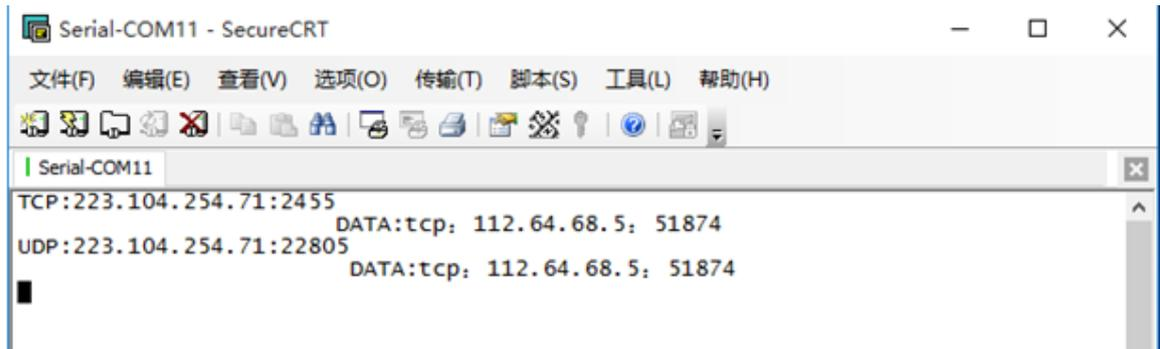
测试服务器按特定的格式回传数据，具体格式如下图，上报的数据作为 DATA 字段的回复内容。
