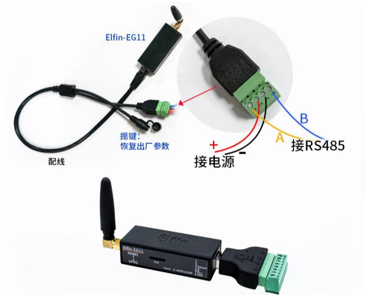
Figure 2. 接口转换线缆
