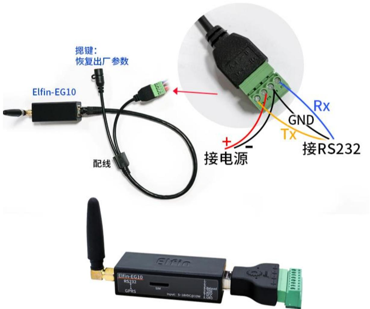
Figure 1. 接口转换线缆
