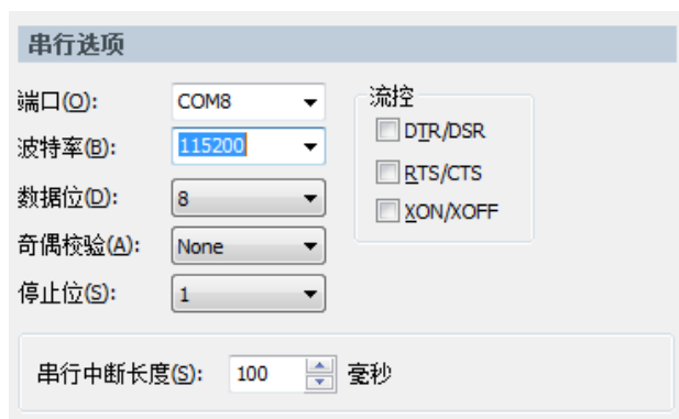
Figure 33. HF-LPB120 缺省 UART 参数
