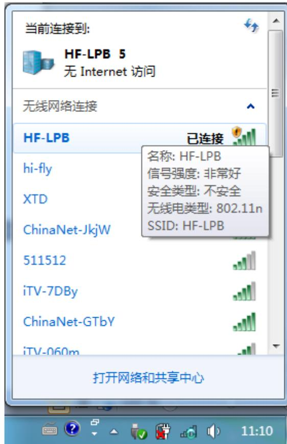
HF-LPB120 在 AP 模式下的 SSID 为 HF-LPB120，如下图所示：
