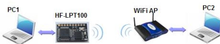
Figure 26. STA 接口连接调试
