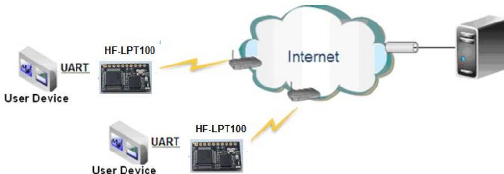
Figure 33. 远程连接应用图示
