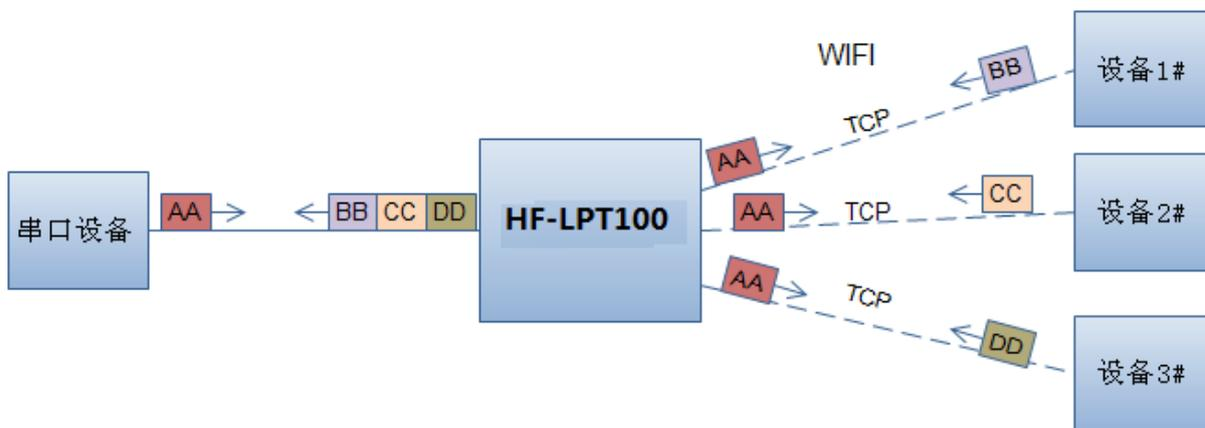
Figure 13. 多 TCP 链接数据传输图示
