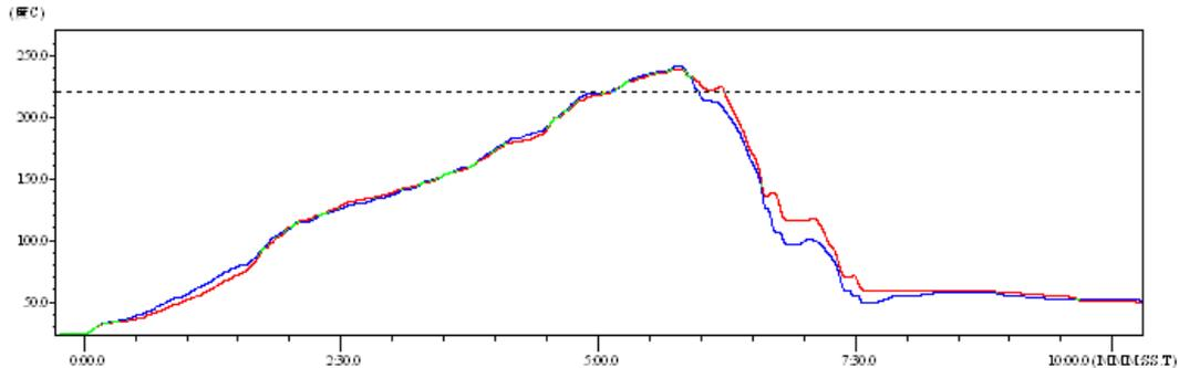
Figure 38. 回流焊焊接温度曲线图
