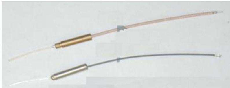
Figure 3. HF-LPT100 外置天线接头示意
