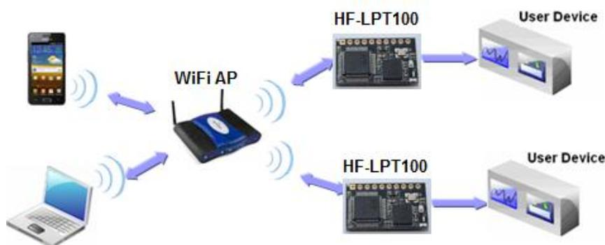
Figure 8. 基本的 HF-LPT100 无线组网结构
