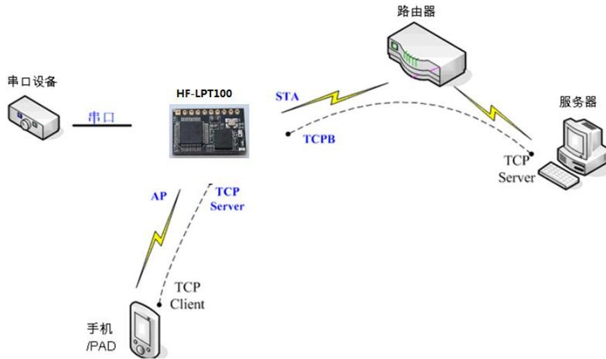
Figure 9. HF-LPT100 的 AP+STA 组网结构
