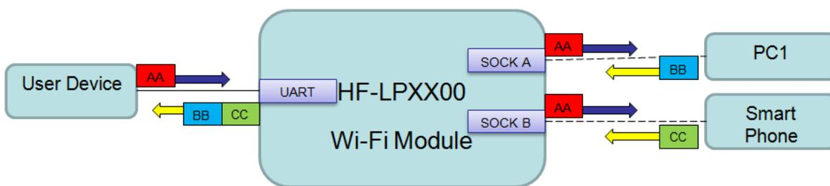
Figure 12. 双 Socket 数据流向示意图
