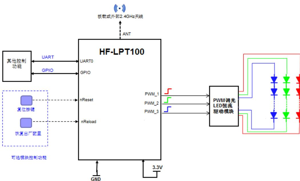
Figure 7. HF-LPT100 智能 LED 应用硬件连接
