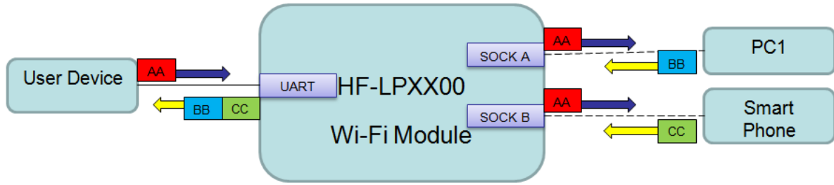
Figure 13. 双 Socket 数据流向示意图
