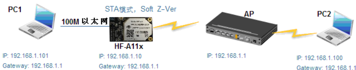
图-21 HF-A11 以太网接口功能（STA Z-Ver）
