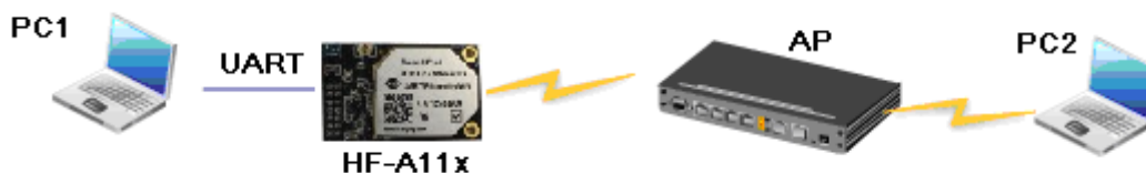
图-31 STA 接口连接调试
