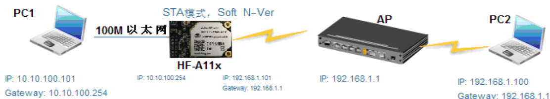
图-20 HF-A11 以太网接口功能（STA N-Ver）
